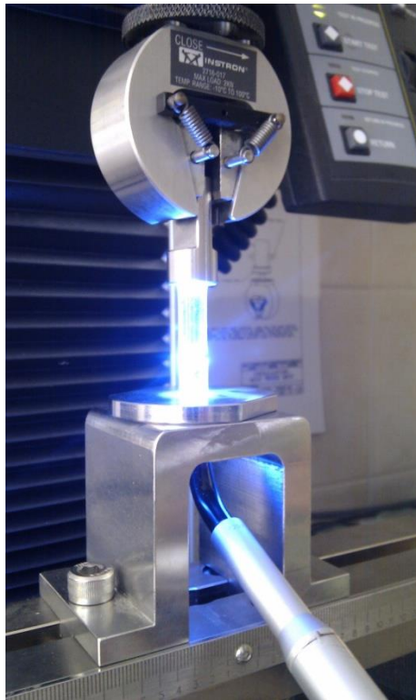
30. ábra: Fotopolimerizációs zsugorodási feszültség mérése mechanikai tesztelő berendezésbe
