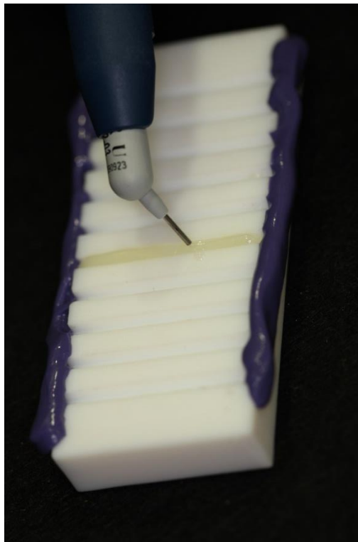
19. ábra: próbatest készítése folyékony kompozitból
