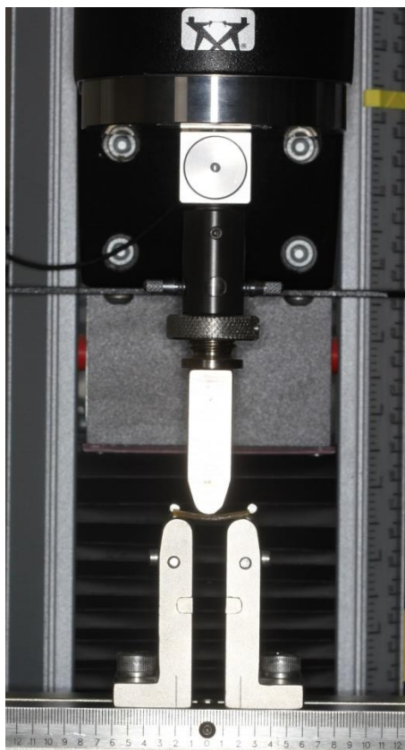
21. ábra: Hajlítószilárdsági vizsgálat mechanikai tesztelő berendezéssel
