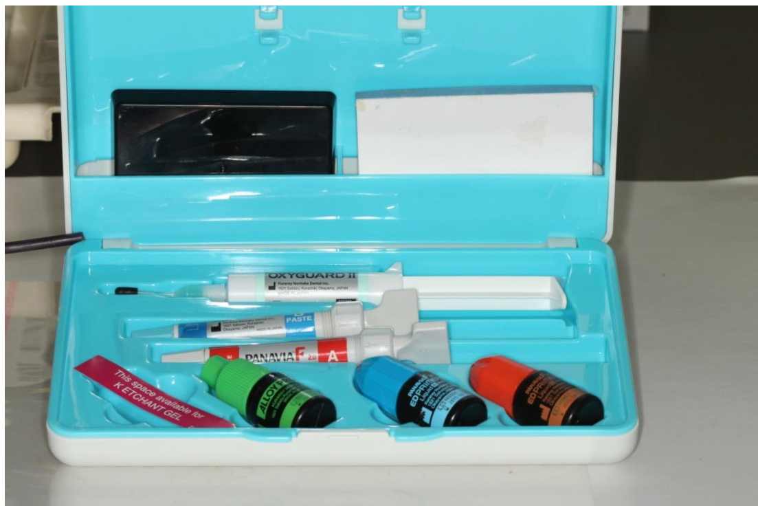
30. ábra: Dual kötésű dimetakrilát ragasztócement csomag tartalma: A és B paszta (szürke fecskendők), fém felszínhez zöld, illetve a foganyaghoz kék és piros használandó primerekkel.
